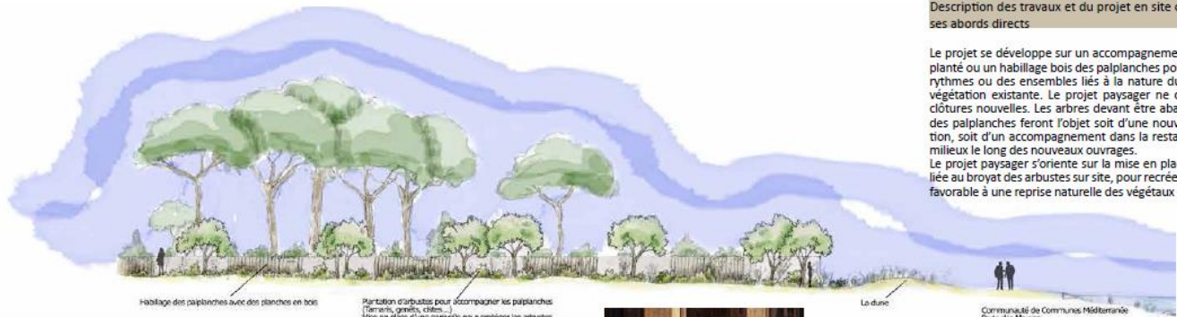
Croquis sur l'habillage des palplanches et l'accompagnement paysager des ouvrages de lutte contre les inondations dans la pinède du Desbrier
